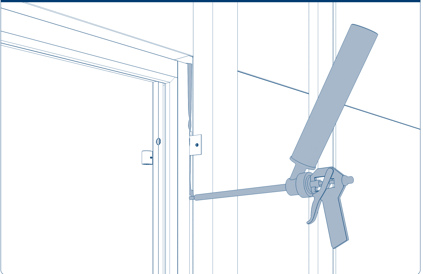
Рис. 10.10. Заполнение зазоров монтажной пеной
